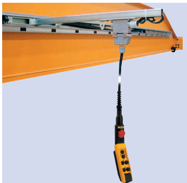
Přenos signálu k závěsnému ovladači
