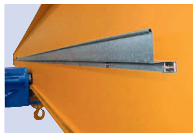
vodící pouzdro přívodu proudu ke kočce
