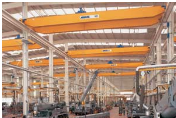
Dvojnosičkové mačky v prevedení D na dvojnosičkových mostových žeriavoch
