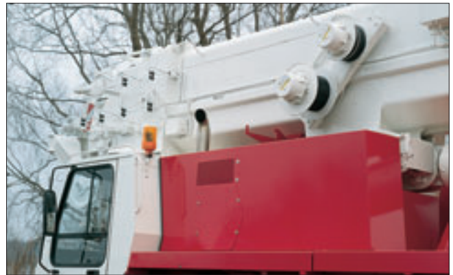
Federleitungstrommel an einem Autokran zur Weg- und Endlagenerfassung des Teleskopauslegers
