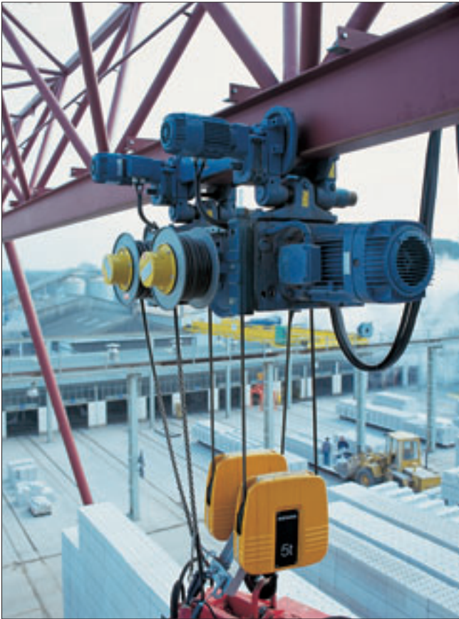
Portalkran mit zwei Federleitungstrommeln für die Haupt- und Steuerstromzuführung des Hubgreifers
