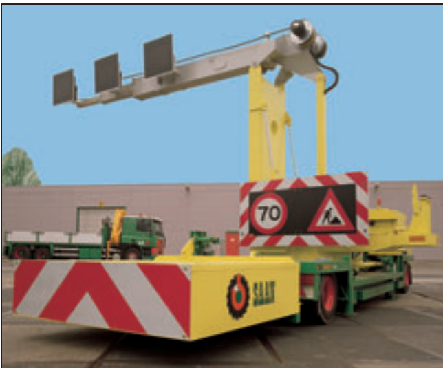
Zwei Federleitungstrommeln im Einsatz auf einer mobilen Autobahnsignalisierung
